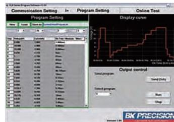
Pass/Failテストでは、電圧・電流の最大・最小値をモニターします。
