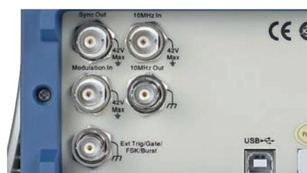
本体背面には10kHzクロックの入力端子と出力端子があります。Sync Out出力端子はTTLパルスを出します。外部トリガ端子はトリガ信号の入力または出力が可能です。
