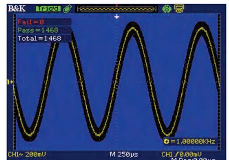
波形の範囲を設定する事で、測定した波形の合否を判定します。
