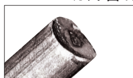
XURON2193型で切断した \phi 1.2\text{mm} のピアノ線の断面
