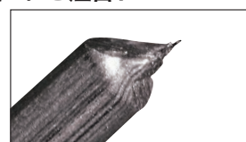
従来の工具で切断した \phi 1.2\text{mm} のピアノ線の断面
