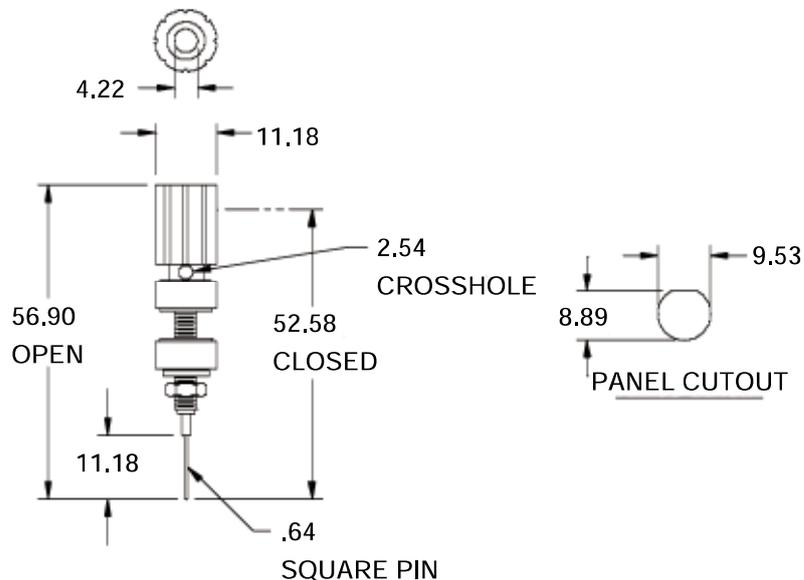
ワイヤラップ工具、機器を使用したワイヤの接続に最適。標準バナナプラグに適合。高密度パッケージ用に細型設計。8-32六角ナット及びロックワッシャ付。2.54mm径横穴は絶縁材上で垂直に切られている。1.57mmから6.35mm厚迄のパネルに装着可能。
