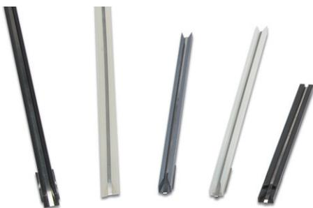
0.15mm厚の導電性ステンレス鋼製インサートは標準スナップイン・ナイロンカードガイド(深溝型、細型、帯電防止型、互換型を含む)に適用し、完全に導電接グラウンドに換える事が出来ます。基板挿入溝に差し込めば、1.9mm幅の導電性床面になり、BIVER社のナイロンカードガイドが導電性に生まれ変わります。
