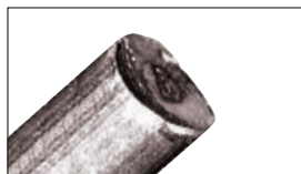
XURON2193型で切断したφ1.2mmのピアノ線の断面
