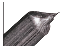
従来の工具で切断したφ1.2mmのピアノ線の断面
