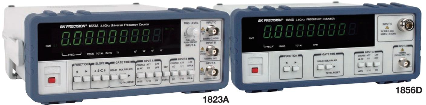
1823A型および1856D型はレシプロカル方式、マイクロプロセッサ制御の2.4GHzおよび3.5GHzの周波数カウンタです。ゲート時間10sの外部タイムベースを使用し、LEDディスプレイは最大9桁の分解能で表示します。高精度、高感度、多機能なこのシリーズのカウンタは科学者、エンジニア、通信技術者にとって研究室から保守までの幅広い用途で、極めて重宝する測定器として活躍します。
