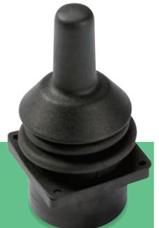
3000シリーズはホール効果を利用した無接点ジョイスティックです。従来の無接点タイプよりもさらにパネル内スペースが小さくなり、金属製ボールピボットで1000万回の機械的寿命(2軸の時)を誇ります。
