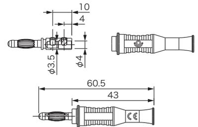
※最大2.5mm<sup>2</sup>のケーブル用ネジ留式端子タイプ
