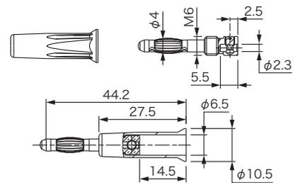
※最大2.5mm<sup>2</sup>のケーブル用ネジ留式端子タイプ
