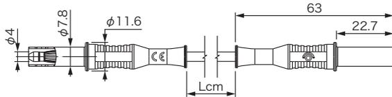
**形状タイプ 2** 片端にφ4mmストレート安全バナナプラグ、他端にφ4mm直角安全バナナプラグ付
