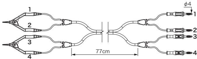
材質/コンタクト: 真鍮ニッケル金メッキ、ケーブル: RG174(50Ω)、PVC0.50mm<sup>2</sup>
