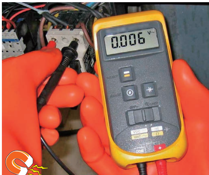
通常のプローブでは両手が塞がる
