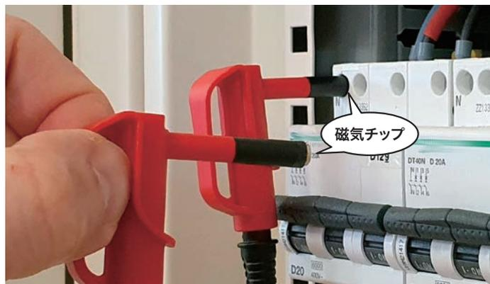
MGPシリーズの磁気アダプタは、様々な端子台の鋼ネジ頭に取り付けられます。もう一方の端は、測定機器に接続する為の4mmバナナメス端子です。
